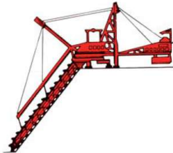
5 Excavateur à godets multiples.
